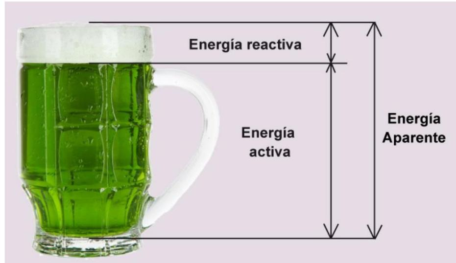
*Se asocia a todos los aparatos que para su funcionamiento precisen de una bobina (es decir aquellos que funcionan con motores o transformadores) alimentados en corriente alterna*
